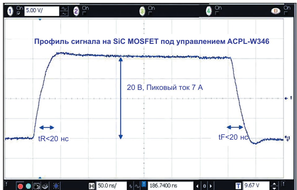
Рис. 2. Профиль сигнала на SiC MOSFET под управлением ACPL-W346
