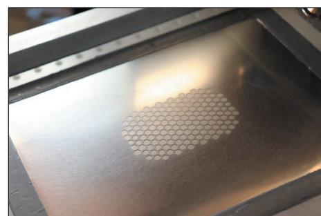
Рис. 9. Модуль XM3 в фиксаторе с полным контактом «трафарет – базовая плата»
