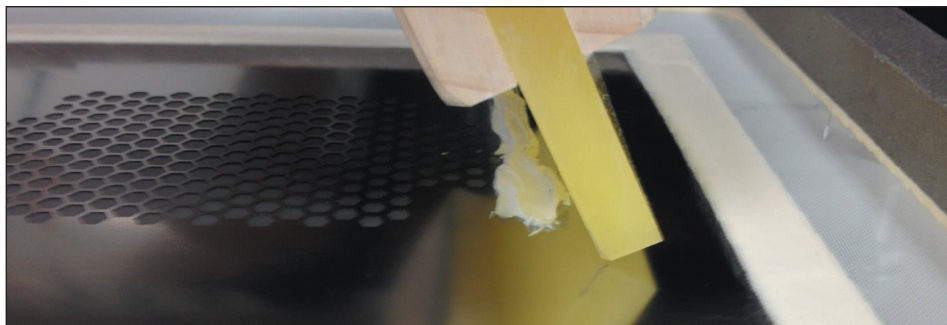
Рис. 12. Рекомендуемый угол наклона ракеля
