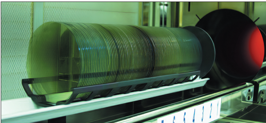
Рис. 1. Подложки диаметром 150 мм теперь используются для массового изготовления SiC-приборов. Почти 18 т 150-мм пластин произведено Wolfspeed в 2016 г. [1]
