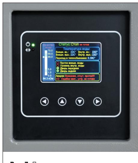
Рис. 7. Панель дисплея управления теплообменной станции «Петра-0395»
