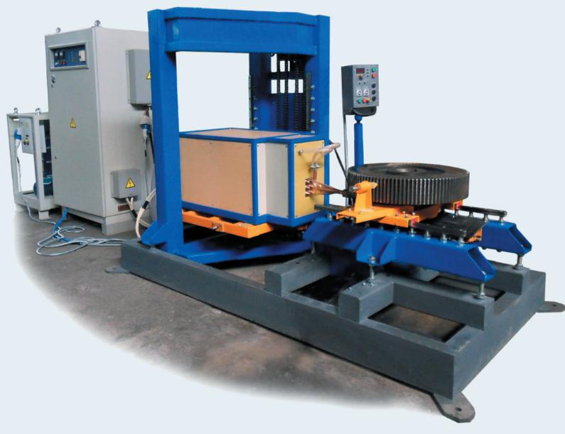
**Рис. 1.** Индукционная установка «Петра» ТВЧ для поверхностной закалки крупномодульных зубчатых колес
