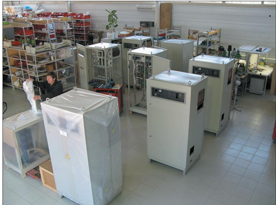
**Рис. 3.** Тиристорные преобразователи частоты «Петра-0120»
