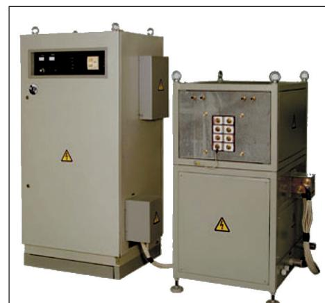
Рис. 8. Общий вид установки ИНУ с тиристорным преобразователем «Петра», с блоком конденсаторным и согласующим трансформатором
