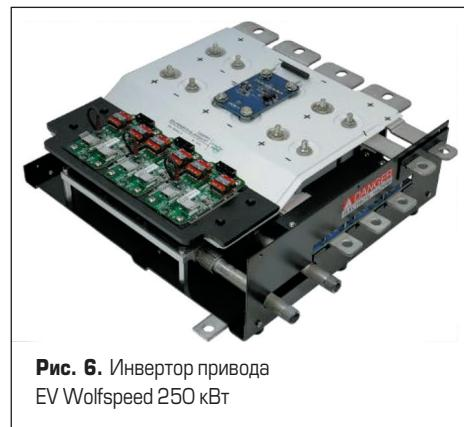
**Рис. 6.** Инвертор привода EV Wolfspeed 250 кВт
