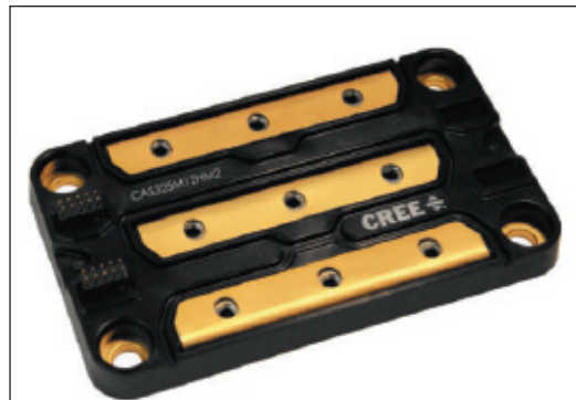
Рис. 1. В 100% SiC-модуле CAS325M12HM2 с индуктивностью корпуса 5,5 нГн использована высокоскоростная распределительная плата для выравнивания динамических характеристик чипов
