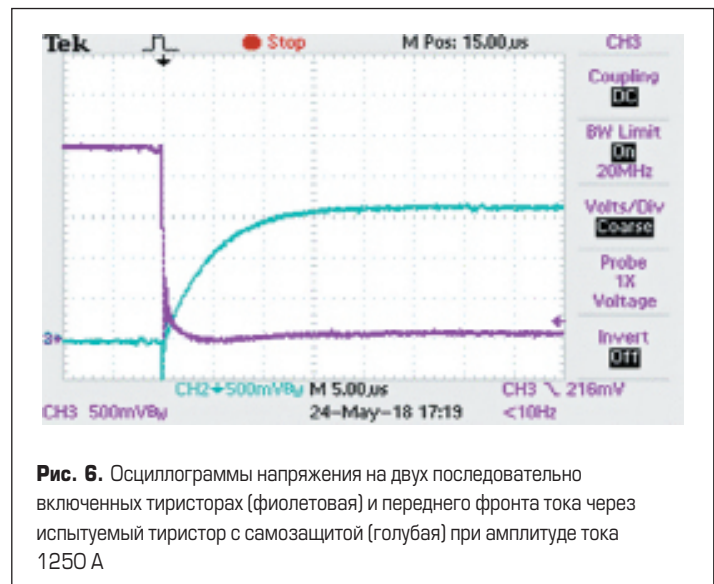
Рис. 5. Осциллограммы напряжения на двух последовательно включенных тиристорах (фиолетовая) и тока через испытуемый тиристор с самозащитой (голубая) при амплитуде тока 1250 А
