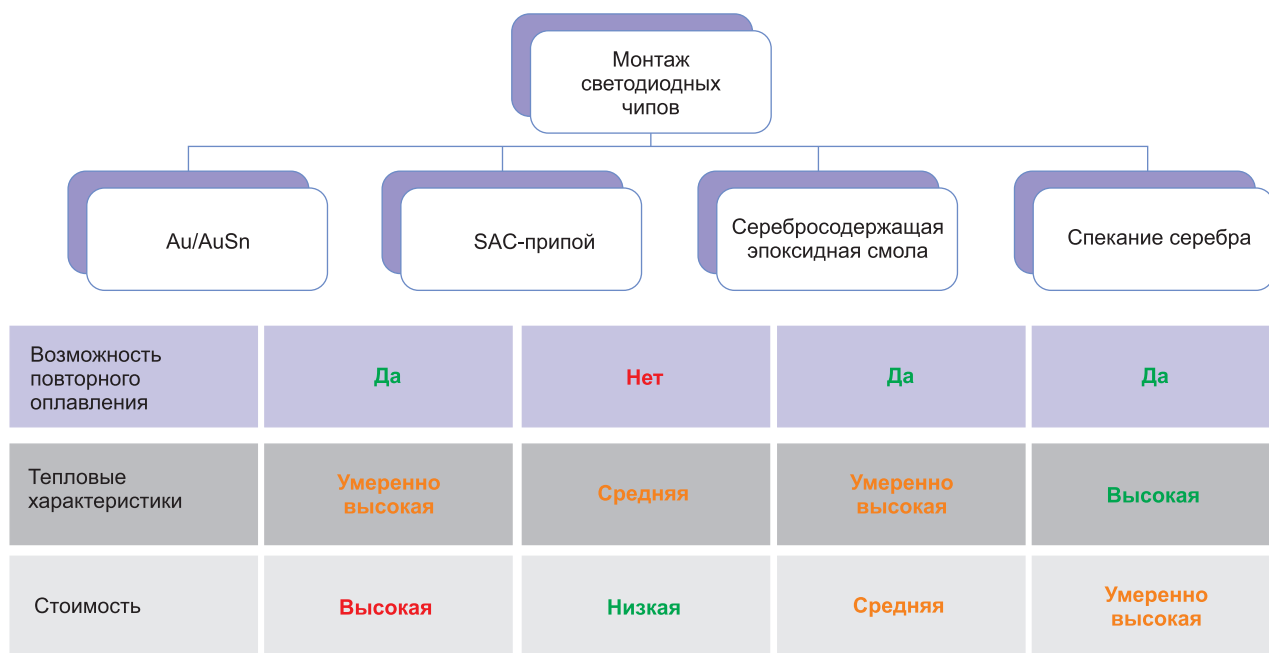
Рис. 4. Сравнение различных технологий монтажа кристалла, подходящих для сборки светодиодов
