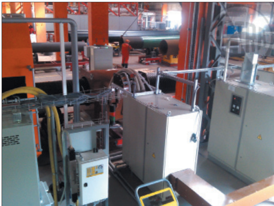
Рис. 9. Технологическая линия индукционного ТВЧ-нагрева для труб большого диаметра
