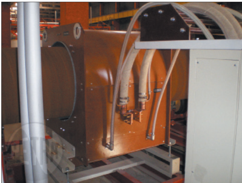
Рис. 8. Подключение индуктора ТВЧ
