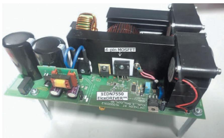
**Рис. 7.** Демонстрационная плата 2,5-кВт ККМ с драйвером 1EDN7550 и четырехвыводным CoolSiC
