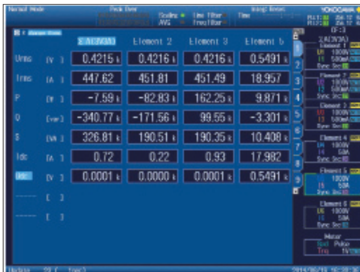
Рис. 18. Снимок экрана измерителя мощности при работе инвертора на номинальной мощности 312 кВА с частотой коммутации 20 кГц
