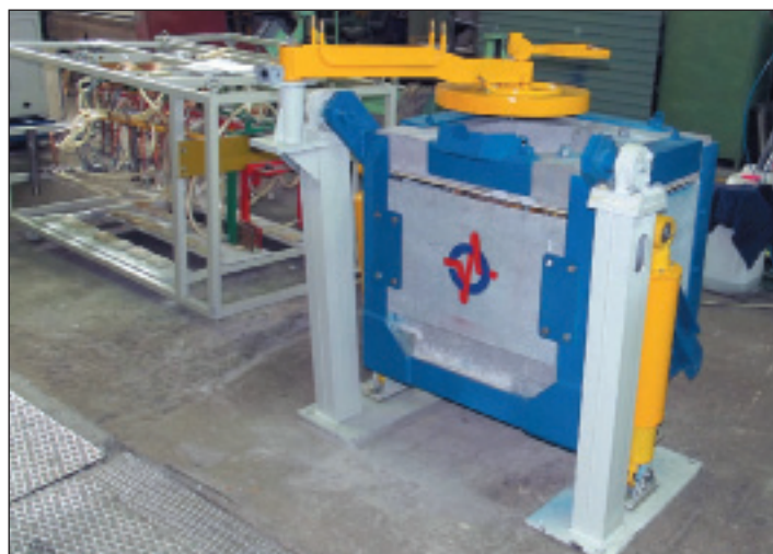
Рис. 13. Конструкция индукционной печи «Содружество»
