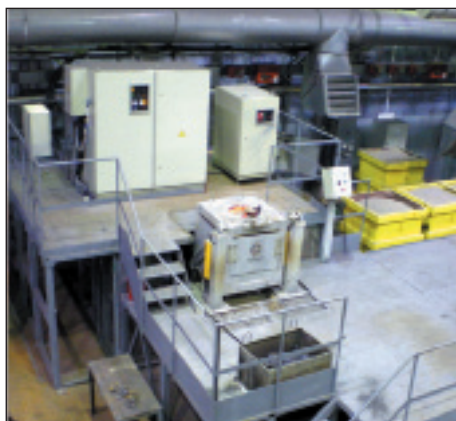
Рис. 1. Установка плавильная с преобразователем частоты «Петра-0141» в составе индукционной печи
