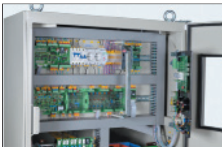
Рис. 6. Система управления ПЧ типа «Петра-0141»
