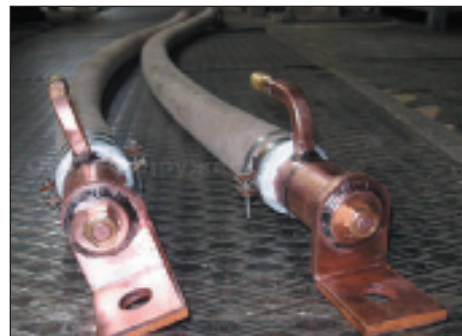
Рис. 16. Водоохлаждаемые силовые кабели
