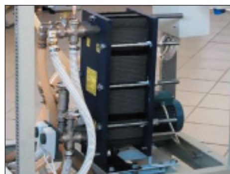
Рис. 10. Пластинчатый теплообменник типа «Петра-0395»
