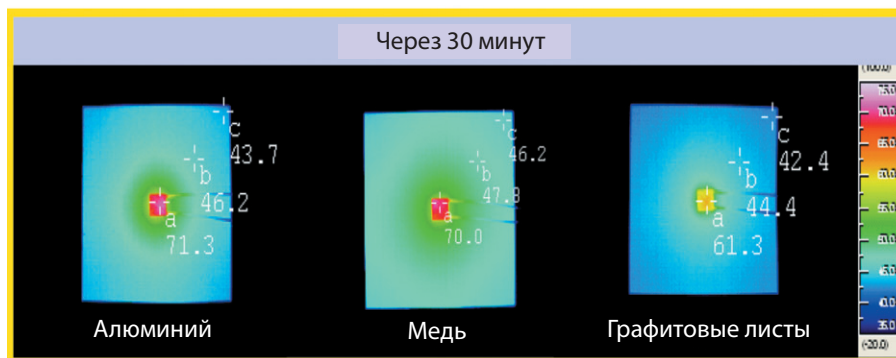
Рис. 6. Сравнение теплопроводности алюминия, меди и PGS-листов
