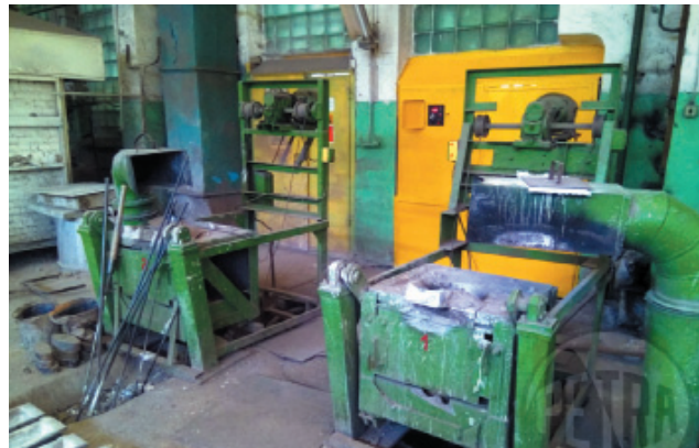
Рис. 10. Литейный участок индукционных печей и установка центробежного литья
