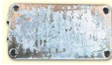
Неравномерность слоя (комковатость)
