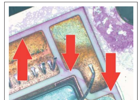
Концентрические трещины в керамической DCB-подложке, проявившиеся после купания в красителе
