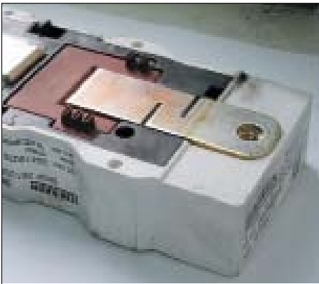
Рис. 7. Прорези для уменьшения механических напряжений в шине
