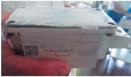
Вязкая паста при монтаже не выдавливается из зазора
