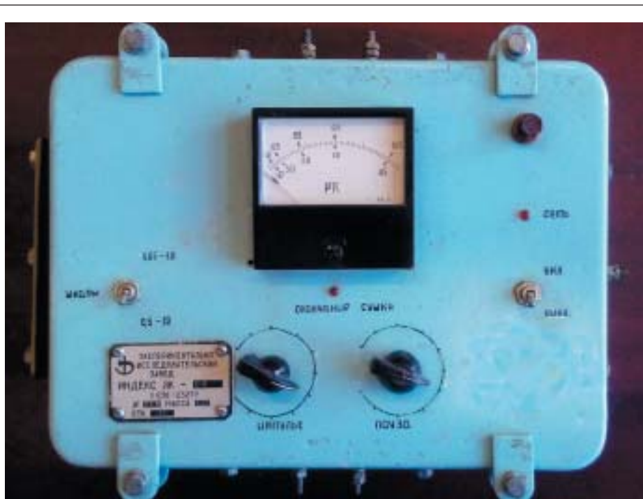
Рис. 3. Лицевая панель с элементами управления и сигнализации портативного устройства для импульсной токовой СИ асинхронных двигателей
