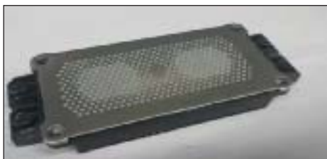
Рис. 5. Типовой вид базовой платы с нанесенной пастой PCM перед монтажом
