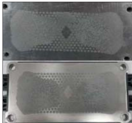
Рис. 7. След термопасты на демонтированном модуле и радиаторе после трех термоциклов +20/+85 °С (не оптимально, но допустимо)
