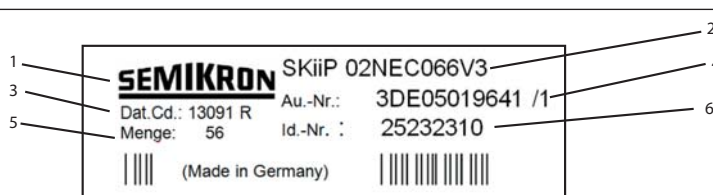
Рис. 17. Информация на этикетке 1. Логотип SEMIKRON. 2. Название модуля. 3. Dat. Cd (Дата-код), шесть цифр в формате YYWWL (YY – год, WW – неделя, L – номер партии). 4. Номер подтверждения отгрузки (Order Confirmation). 5. Menge (QTY): количество модулей в упаковке (входит в QR-код). 6. Id.-Nr.: каталожный номер SEMIKRON (входит в QR-код), QR-код (штрих-код) выполняется по стандарту EEC 200 в формате 19/9
