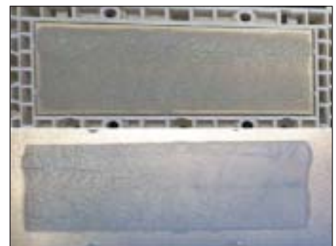
Рис. 12. След термопасты на демонтированном модуле и радиаторе после трех термоциклов +20/+85 °С (оптимально)
