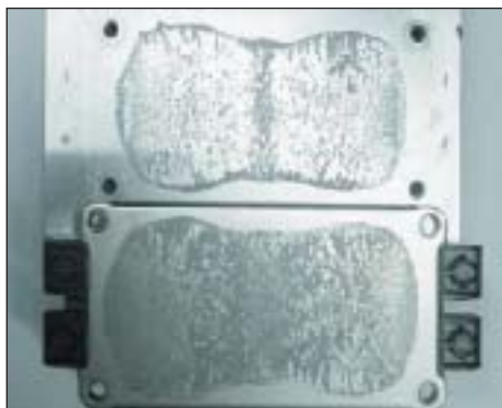
Рис. 6. След термопасты на демонтированном модуле и радиаторе после трех термоциклов +20/+85 °С (оптимальный вариант)
