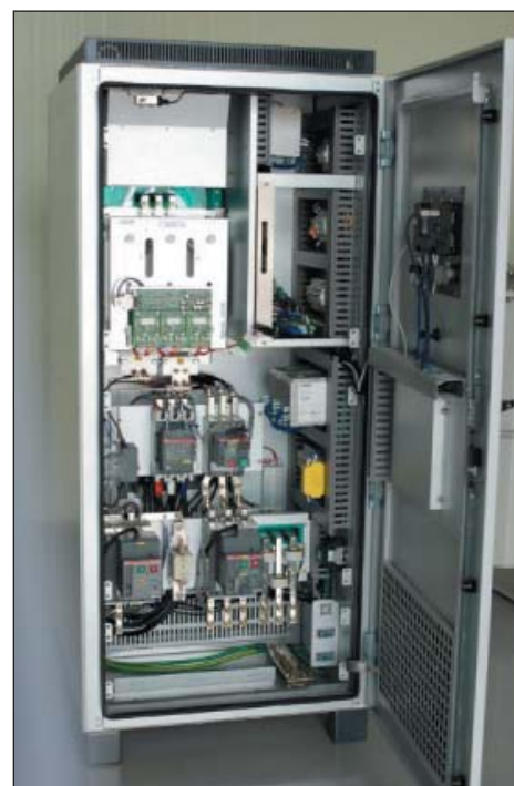
Рис. 2. Раскрытый шкаф преобразователя ELT-BESS-125 кВт, входное напряжение 550–820 В DC, выходное напряжение трехфазное, 380 В DC ±10%, номинальная частота 50/60 Гц, коэффициент гармоник <5%. Диапазон рабочих температур –20...+50(70) °C. Охлаждение — воздушное принудительное. Степень защиты IP2X. Размеры 800×1000×1670 мм, масса около 1,2 т
