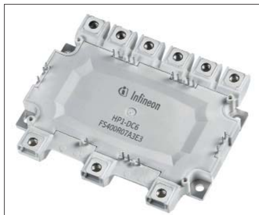
Рис. 1. IGBT-модуль HybridPACK1-DC6 рассчитан на напряжение 705 В и номинальный ток 400 А. Благодаря шести клеммам шины постоянного тока эта конструкция имеет очень низкую паразитную индуктивность
