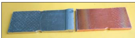
Рис. 4. Результат испытания на статическое растяжение образца сварного шва АМг5-М1
