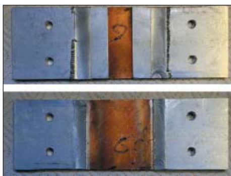
Рис. 7. Образец комбинированной шины, полученный сваркой пластины М1 толщиной 3 мм и пластин сплава АА 6060 толщиной 5 мм.
