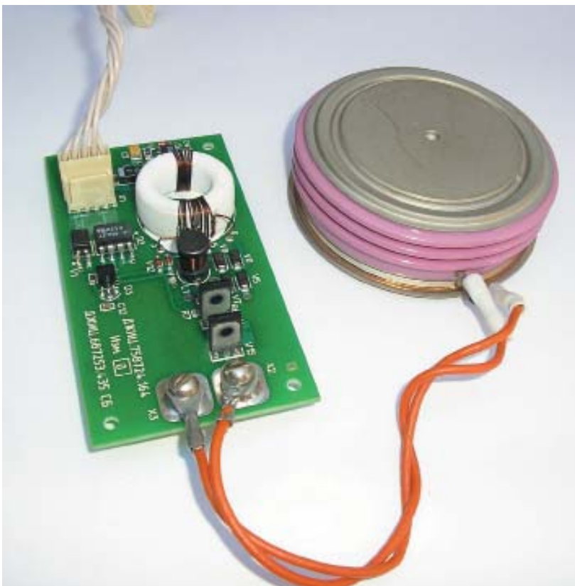
Рис. 4. Внешний вид платы тиристорного драйвера ДРТ11-5-2ОП1К-1
