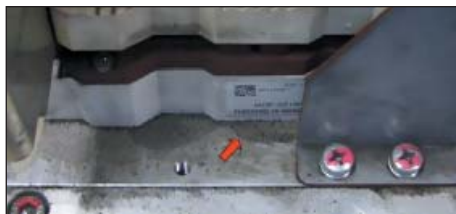
Рис. 6. Следы присутствия жидкости на радиаторе модуля SKiIP
