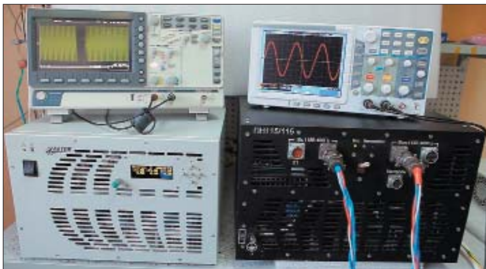
Рис. 7. Проведение испытаний ПН115/115 на воздействие переходных искажений СЭС. Провал напряжения на 120 мс
