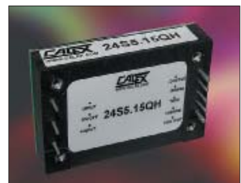
Рис. 1. Внешний вид DC/DC-преобразователей серии QH
