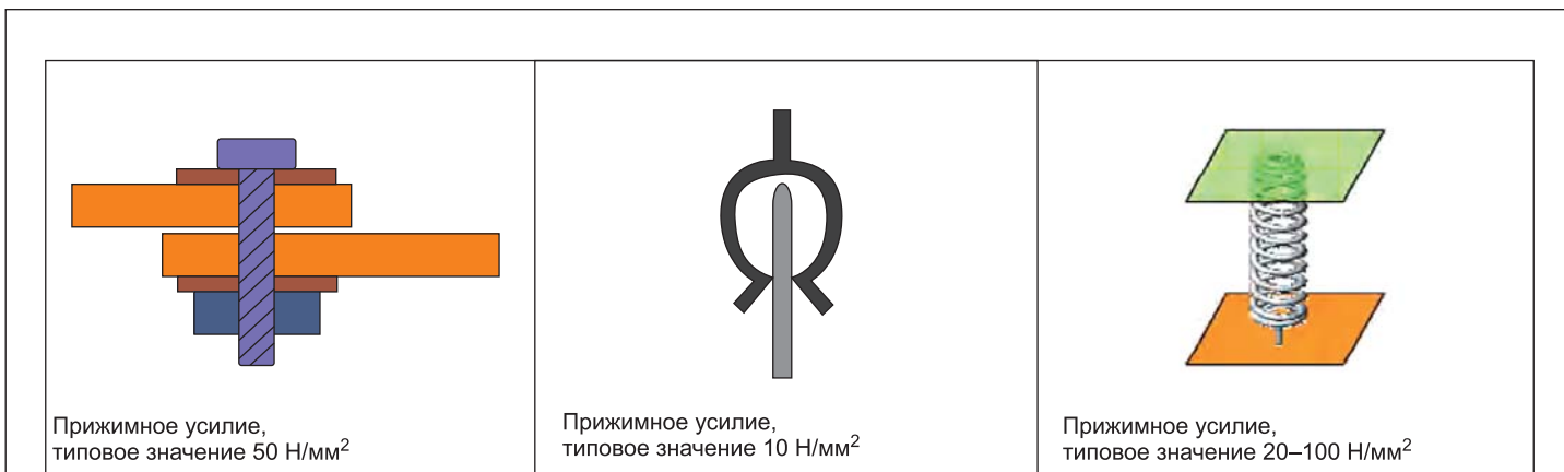
Рис. 8. Сравнение контактных свойств основных типовых электрических коннекторов: винтовое соединение, штыревой разъем (plug-in), пружинный контакт
