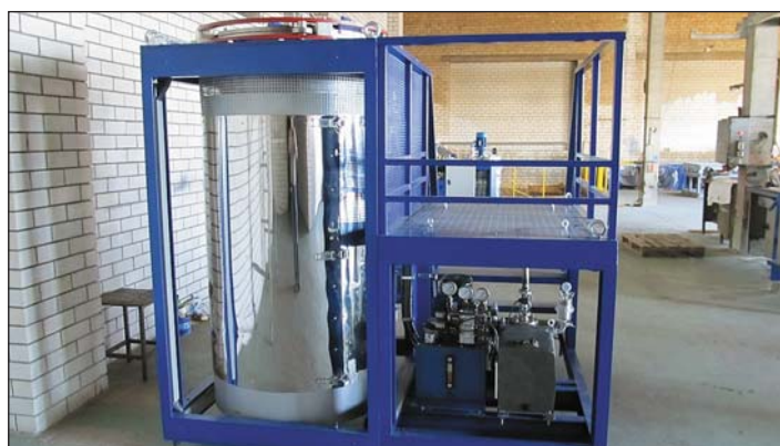
Рис. 9. Крупногабаритная установка вакуумной сушишки, вид сбоку
