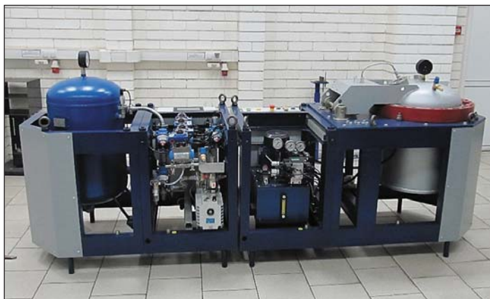
Рис. 3. Установка ВНП с ресивером. Модули, в целях обеспечения безопасности производства, могут быть установлены в разных помещениях
