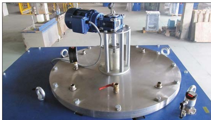
Рис. 8. Электрический привод миксера установлен на крышке бака подготовки
