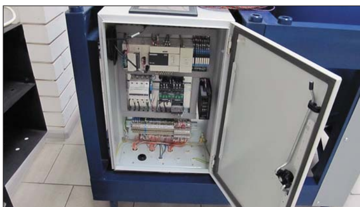
Рис. 5. Управляющий контроллер и электрические цепи установки
