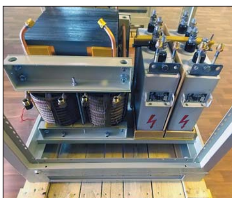
Рис. 10. Размещение дросселя постоянного тока и силовых конденсаторов
