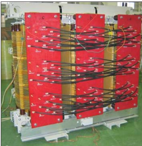
Рис. 9. Многоуровневый трансформатор производства компании «Электрофизика» (С.-Петербург)
