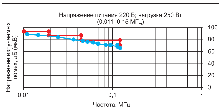
Рис. 5. Зависимость напряжения излучаемых помех от частоты при напряжении питающей сети 220 В и нагрузке 250 Вт в диапазоне частот 0,011–0,15 МГц
