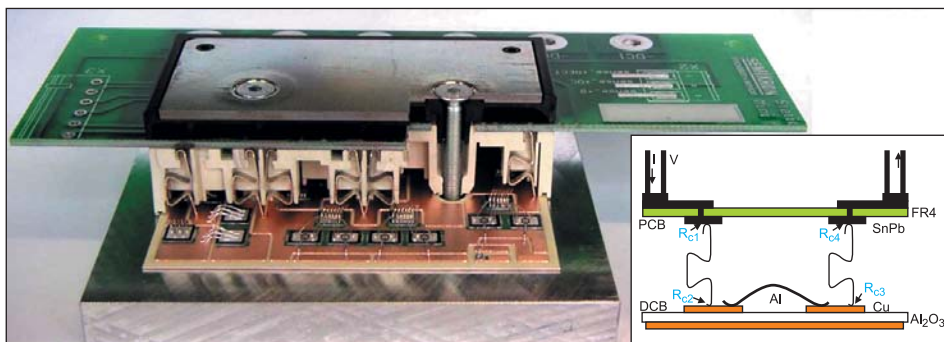
Рис. 7. Прижимная сборка модуля MiniSKiiP, схема измерения контактного сопротивления
