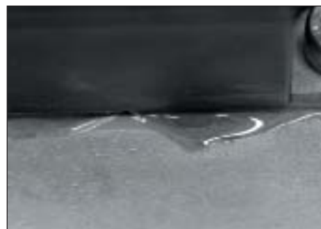
Рис. 4. Изменение структуры ТИМ при воздействии термомеханических напряжений (паста превратилась в жидкий гель и вытекла из зазора)
