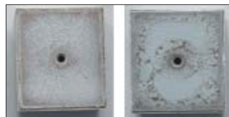
Рис. 11. Толщина слоя: а) оптимальная; б) недостаточная
