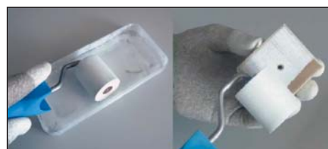
Рис. 5. Нанесение пасты с помощью резинового ролика
