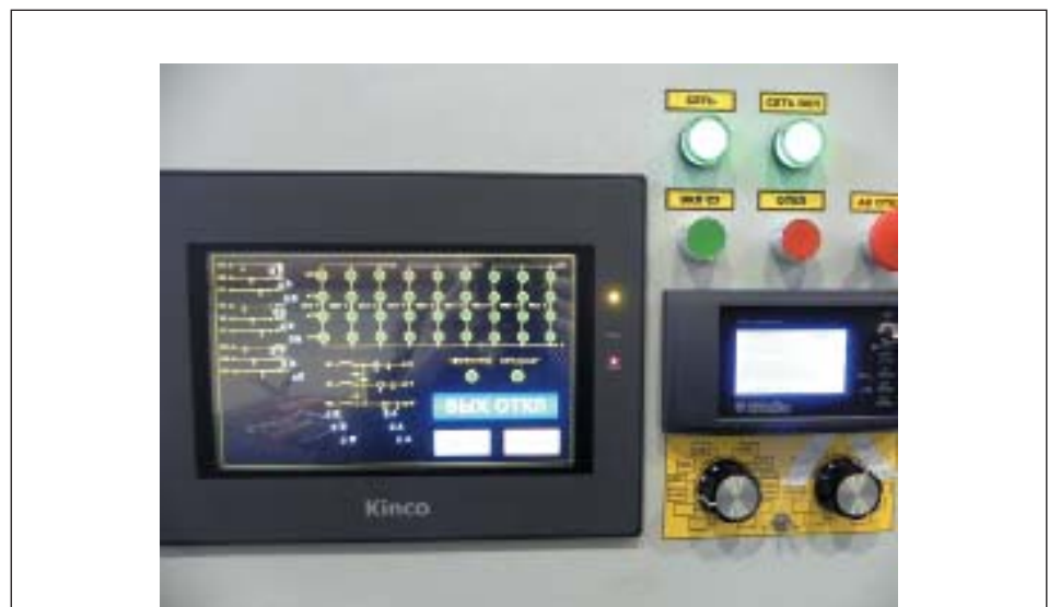
Рис. 19. Панель управления НПЧ
