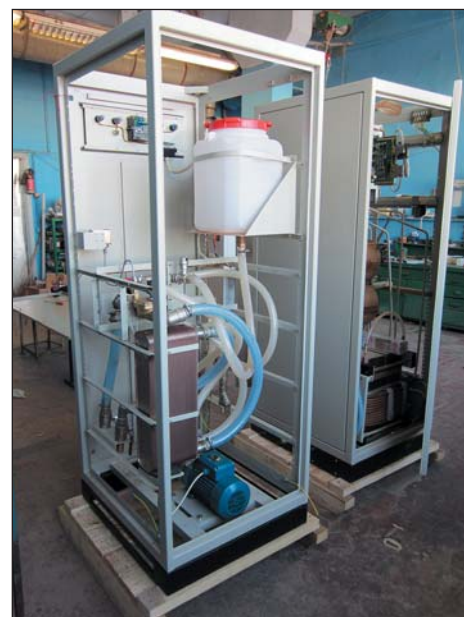
Рис. 3. Элементы конструкции станции охлаждения ПАРАЛЛЕЛЬ СО-60
