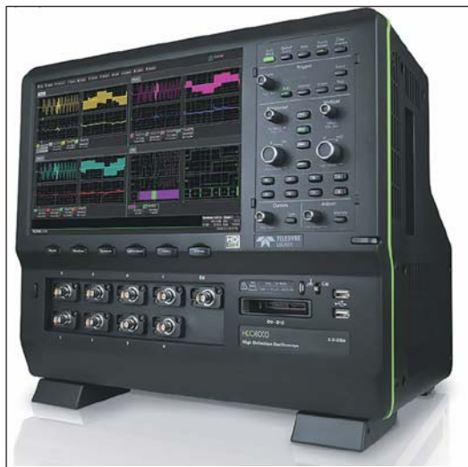
Рис. 1. Восьмиканальный осциллограф/анализатор высокой четкости для анализа мощности электродвигателей и их приводов
