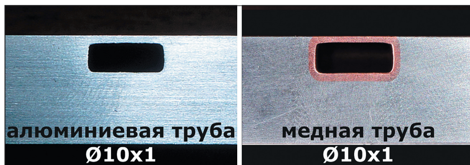
Рис. 3. Различная форма сечения трубных каналов на поперечных срезах. Бесщелевая запрессовка
