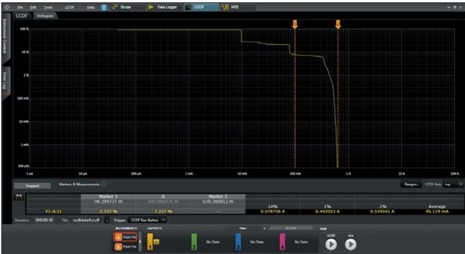
Рис. 4. Комплементарная интегральная функция распределения: 1) ток спящего режима; 2) ток при отображении результатов измерения давления; 3) ток во время измерения кровяного давления; 4) пиковый ток компрессора. Маркеры показывают, что в течение 7,7% от длины записи потреблено более 100 мАс.
