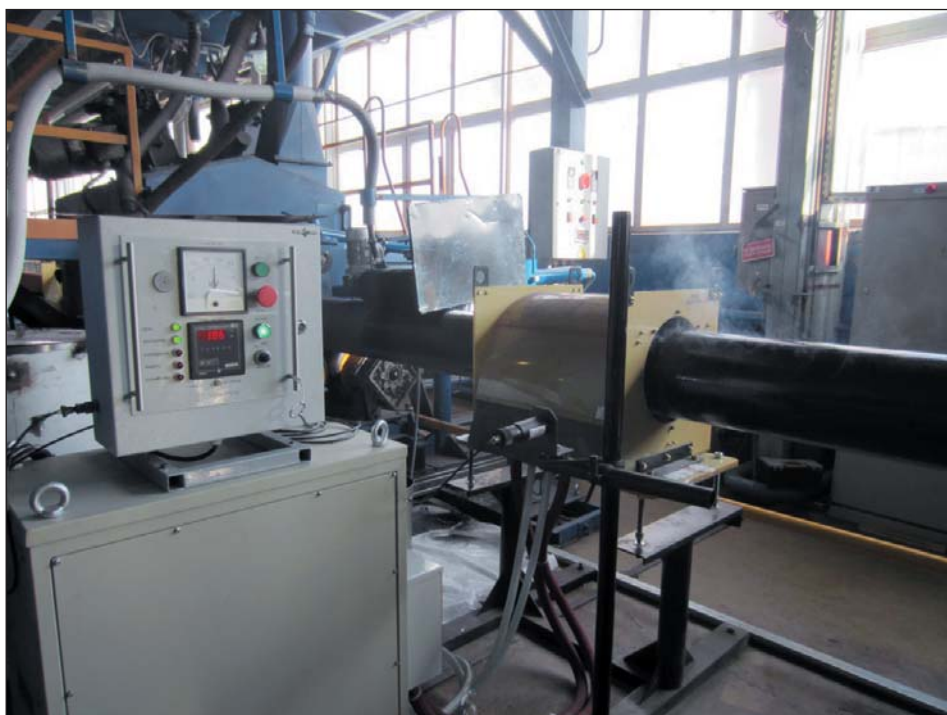
Рис. 8. Автоматическая линия нагрева трубы большого диаметра
