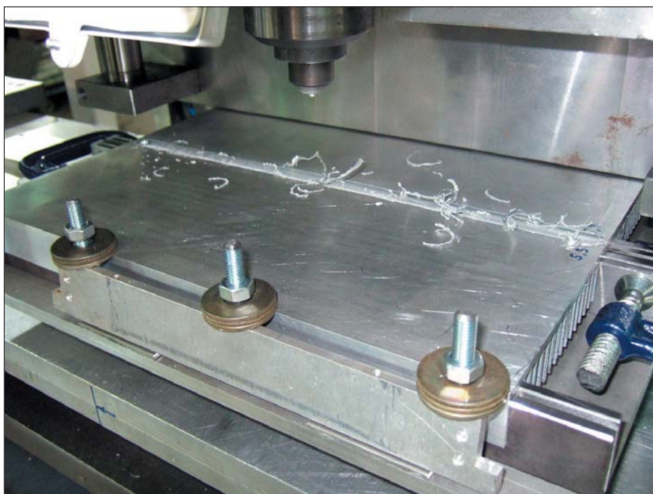
Рис. 4. Результат сварки заготовок на лабораторной установке
