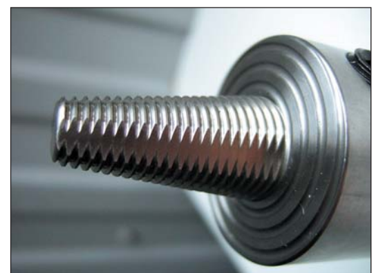
Рис. 2. Типовой инструмент для сварки трением с перемешиванием алюминиевых сплавов
