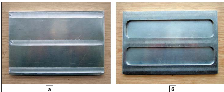
Рис. 6. Приварка пластины к основанию нахлесточным швом: а) лицевая сторона шва; б) обратная сторона
