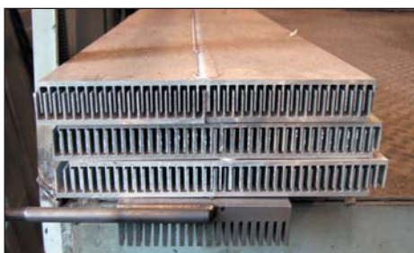
Рис. 5. Опытная партия охладителей, сваренная на промышленной установке
