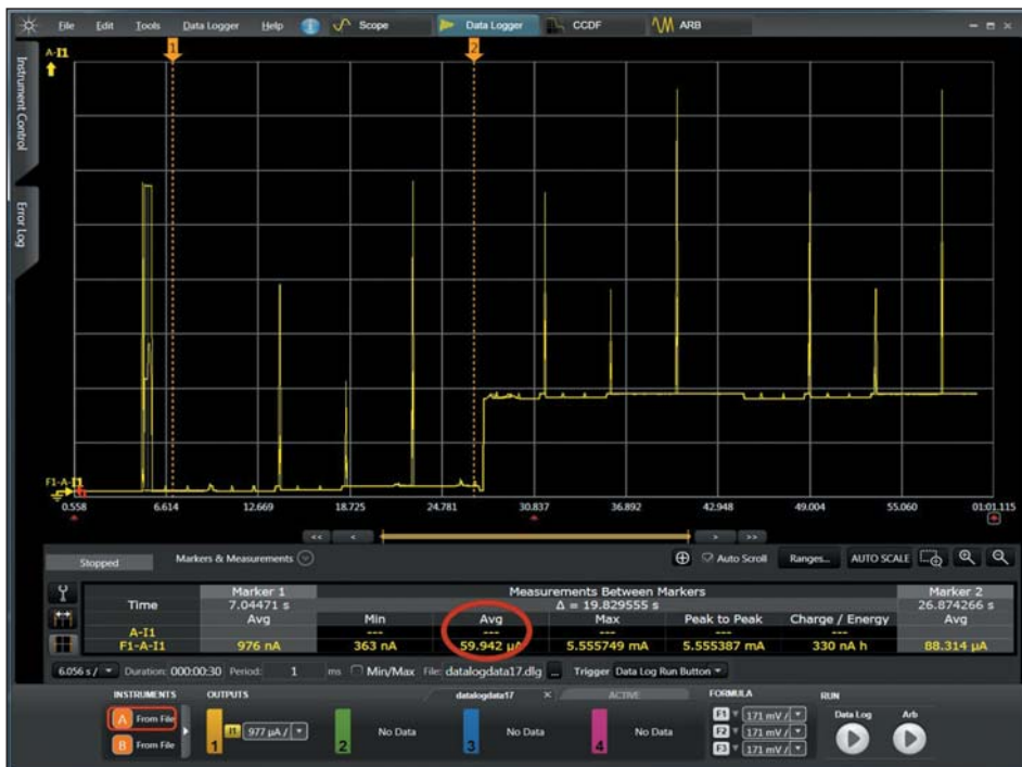
Рис. 4. ПО управления и анализа Agilent 14585A можно использовать для определения времени работы от батарей
