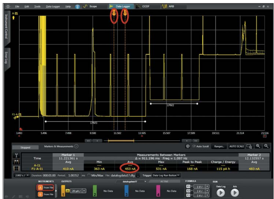
Рис. 3. В окне ПО управления и анализа Agilent 14585A показано использование маркеров для определения режимов питания процессора
