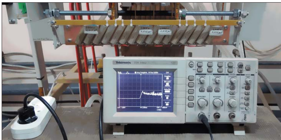
Рис. 2. Исследование электромагнитных процессов в снабберных элементах IGBT-модулей
