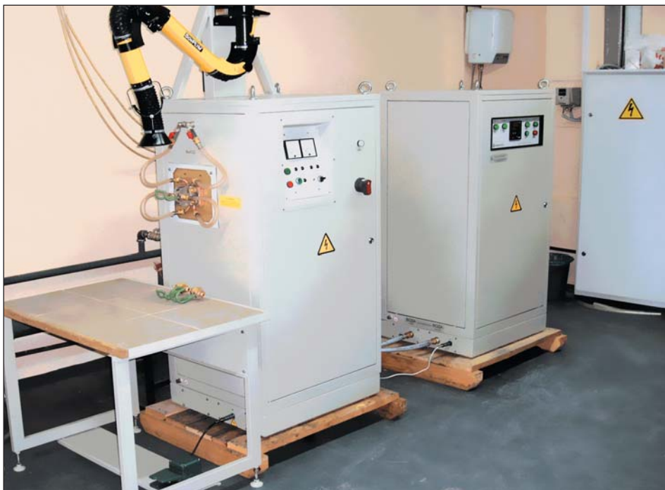
Рис. 3. Индукционная установка для пайки режущего инструмента токами ВЧ
