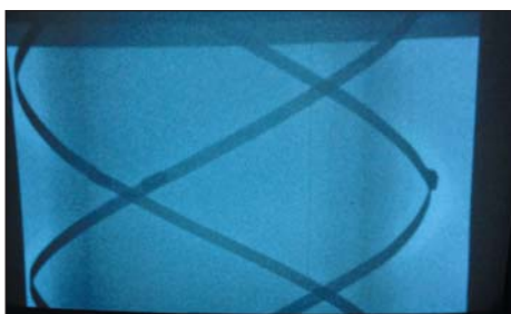
Рис. 2. Рентген-снимок предохранителя на этапе контроля сборки
