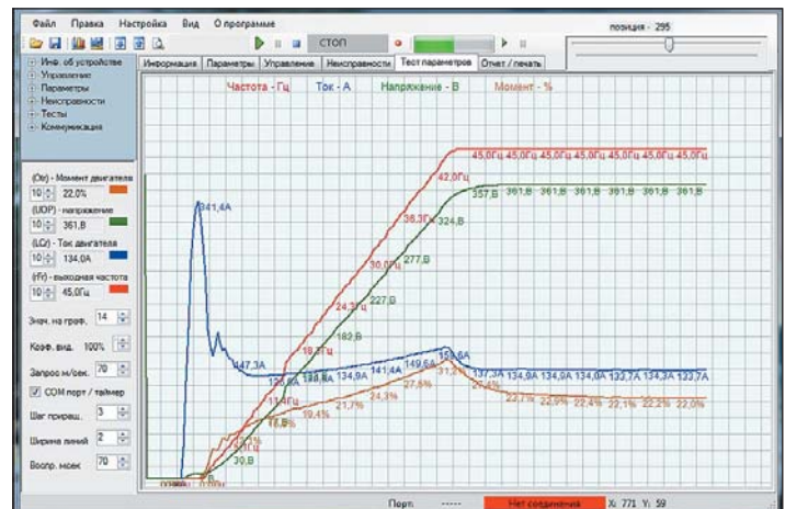
Рис. 5. Закон управления векторный без датчика обратной связи
