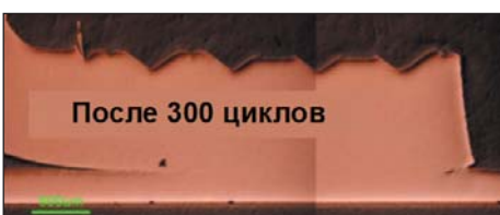
Рис. 3. Сечение ультразвукового соединения после 300 термоциклов (–40...+150 °С)
