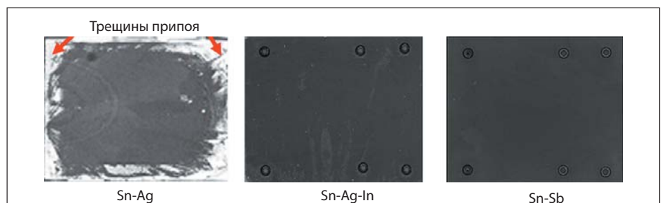
Рис. 5. Сравнение площади расслоения для припоев Sn-Ag, Sn-Ag-In и Sn-Sb между медным основанием и Si 3 N 4 DBC
