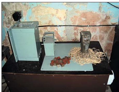
Рис. 8. Экспериментальный макет установки размагничивания
