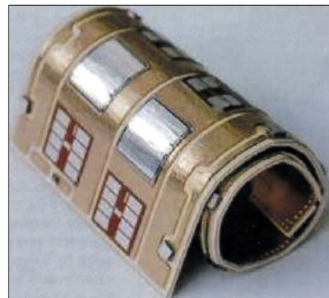
Рис. 4. Тест «на скручивание» показывает высокую устойчивость спеченного соединения к механическим воздействиям
