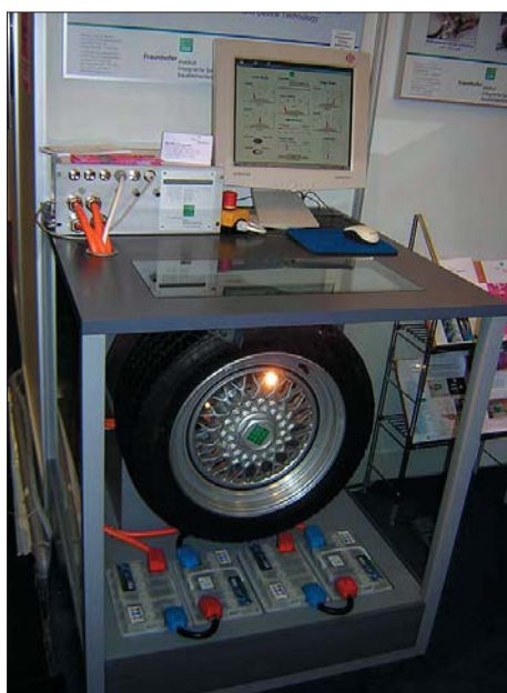
Рис. 6. Мотор-колесо с электроприводом мощностью 100 кВт · А
