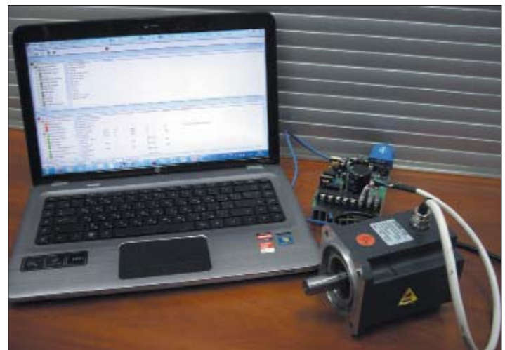
Рис. 6. Преобразователь IRMCS3041 с подключенным демонстрационным образцом двигателя
