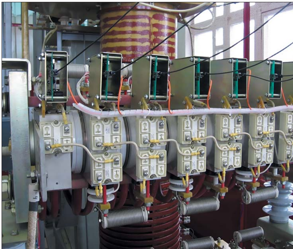
Рис. 6. Опытный образец модуля тиристорного ключа на основе фототиристоров ТФ193-2500
