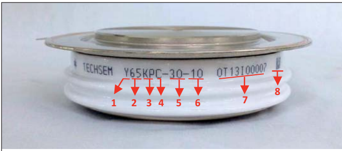
Рис. 4. Маркировка прибора капсульного типа: 1 — код капсульного прибора; 2 — диаметр используемого чипа; 3 — тип чипа; 4 — код спецификации подложки; 5 — код рейтинга прямого тока; 6 — код рейтинга обратного напряжения; 7 — код даты выпуска; 8 — матричный код, содержащий сведения о продукте, номерах партий, производственной и измерительной линий и о дате выпуска
