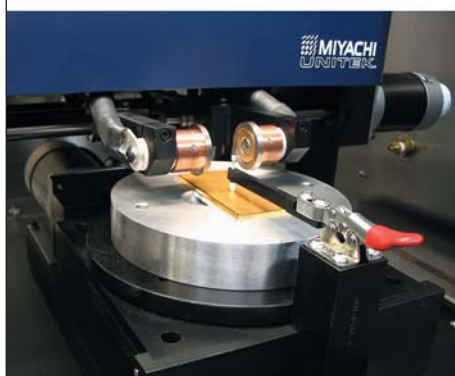
Рис. 11. Групповая и одиночная шовно-роликовая сварка
