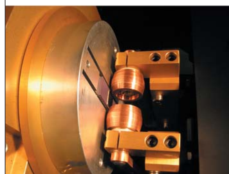
Рис. 12. Различные типы роликов, применяемых в шовно-роликовой сварке
